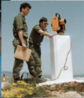
38. Μετρήσεις πλευρών και γωνιών τριγωνομετρικού δικτύου με κλασικά όργανα μέτρησης.
