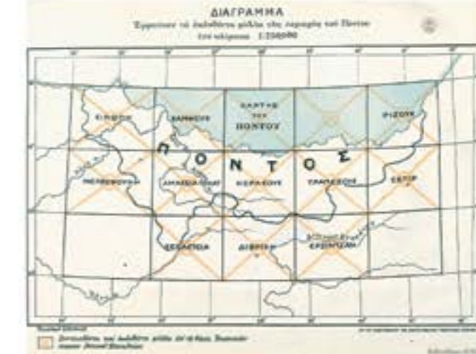
Διανομή των φύλλων χάρτη με τις ονομασίες τους και διαγράμματα προόδου των γεωδαιτικών (τριγωνισμός) και χαρτογραφικών εργασιών (1921) επί του εδάφους, σε διάφορες κλίμακες τοπογραφικών αποτυπώσεων
