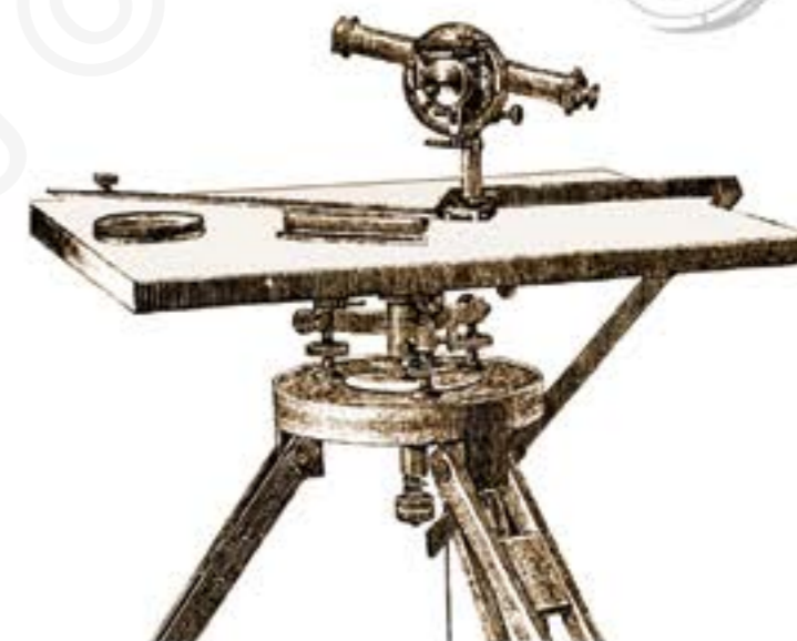
Η μετροτράπεζα (Messtisch-Apparat). Το κύριο όργανο τοπογραφικής αποτύπωσης
